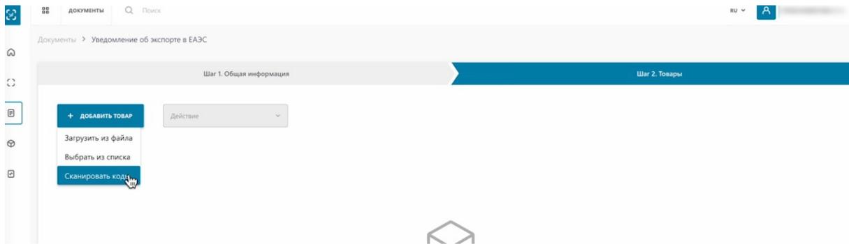
Перед началом сканирования кодов маркировки выставляем английский язык ввода, наводим мышку на поле для отображения кодов и активируем его нажатием, как указано в инструкции к данному полю.
